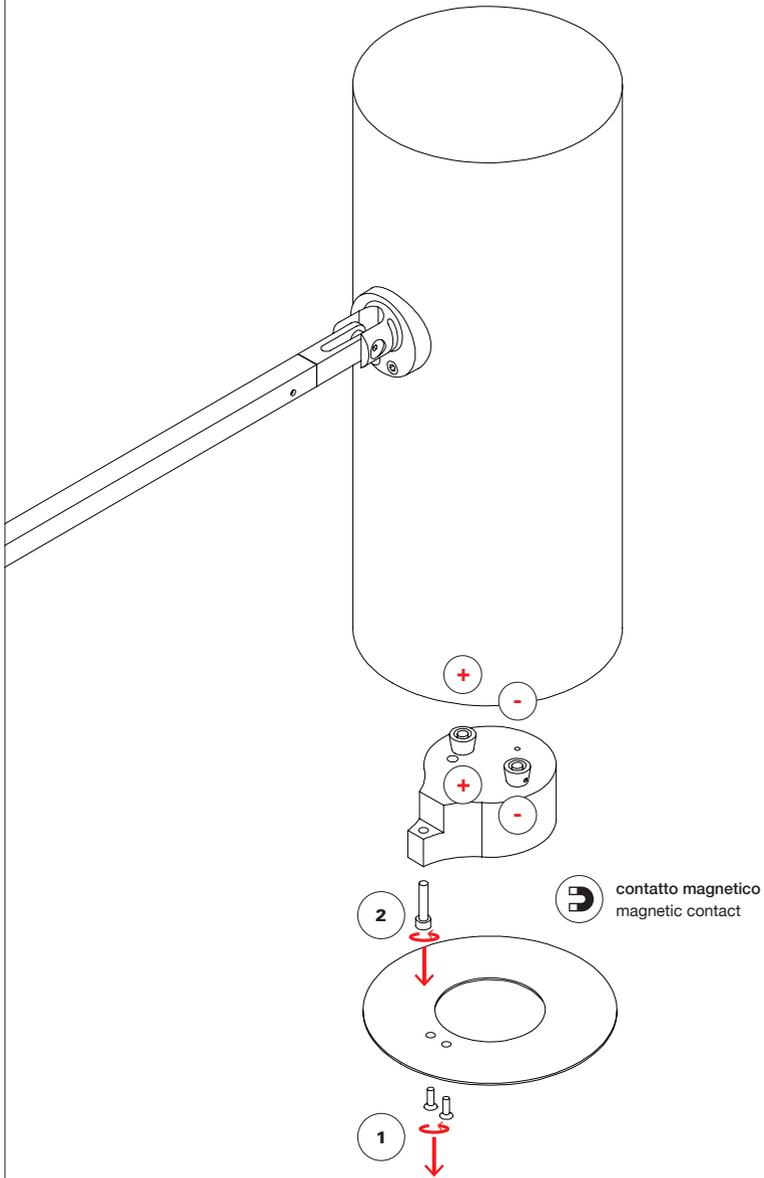
sostituzione LED superiore / top LED replacement
