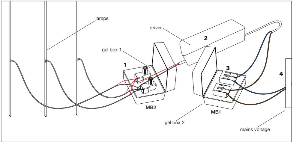
sostituzione lampadina / bulb replacement
